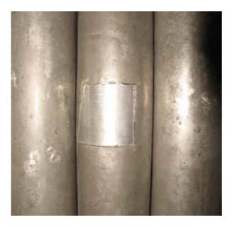
Es wurde von uns durch Einlöten eines Stückes aus altem Material ersetzt.
