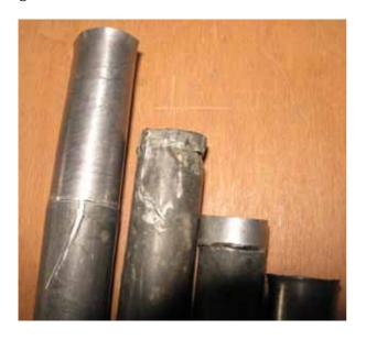
Die Mündungen wurden, da das Pfeifwerk ohnehin für die mitteltönige Stimmung geändert werden mußte, soweit erforderlich, abgeschnitten und neu angelängt. Drei Pfeifen, die vom Material und der Bauweise her in keiner Weise paßten, wurden neu angefertigt; alles übrige Material wurde wiederverwendet. Für die Anlängungen wurde gegossenes, gehämmertes und von Hand abgezogenes Material mit der entsprechenden Legierung verwendet.
