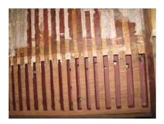
Die Kanzellen sind aus dem massiven Holz herausgestemmt und mit Bolus ausgegossen worden. Die Kanzellen waren an der Unterseite mit quer zum Kanzellenkorpus verlaufendem Holz verspundet. Durch den unterschiedlichen Maserungsverlauf hat das Holz sehr stark gearbeitet, sodaß es Risse an der Unterseite der Kanzellen gab. Die Spunde wurden durch in gleicher Maserrichtung verlaufende Nußbaum-Spunde ersetzt und die Unterseite neu beledert. Damit ist gewährleistet, daß die Lade nicht mehr reißt.
