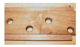
Außerdem wurden sie am Registerwellen-Angriffspunkt aufgedoppelt, da sie von dem Wellenarm nur sehr knapp beaufschlagt wurden.
