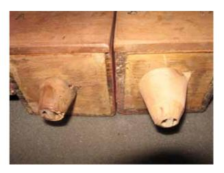
Alle Holzpfeifen wurden mit Warmleim ausgegossen, um alle Löcher zu schließen. Es wurden zudem gerissene Pfeifen ausgespänt und Füße repariert. Etliche Pfeifen waren bereits mehrfach (!) und sehr provisorisch angelängt worden. Die Anlängungen waren aus unpassenden Hölzern und mit teilweise viel zu starken Wandungsstärken gemacht. Diese handwerklich nicht tragbaren Anlängungen wurden entfernt und die Pfeifen neu mit Kastanienholz auf das erforderliche Längenmaß gebracht.
