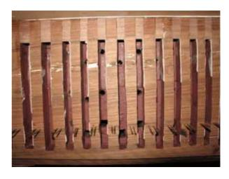
Bis auf die teilweise erneuerten Pulpeten war die Windlade original erhalten. Die Rückwand des Windkastens bestand sehr einfach aus zwei Brettern, die mit Lederstreifen zwischen die Seitenwände und einen Mittelsteg geleimt waren.
