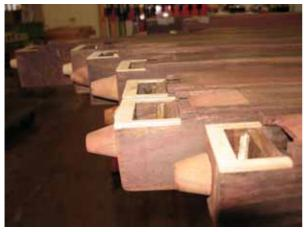
Die Kerne bestehen aus Querholz, das einfach zwischen die Pfeifenwandungen eingeleimt und mit Leder fixiert und abgedichtet worden war. Die Kerne waren an den Kernkanten teils erneuert, teils grob bearbeitet worden.
