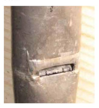
Die Fußöffnungen waren äußerst unterschiedlich. Völlig offene Füße befanden sich direkt neben fast ganz geschlossenen Füßen. Um die Pfeifen ausbeulen zu können, mußten die Füße geöffnet werden. Sie wurden nach der erfolgten Überarbeitung durch Zukulpen soweit geschlossen, daß die Pfeifen sicher in den Stock-Kesselungen standen.
