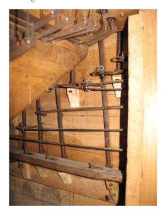
Einzelne Arme waren aufgeplatzt und wurden zugelötet. Die Verbindungsstifte zwischen Wellenarmen und Registerzugstangen waren viel zu klein, sodaß die Traktur sehr wackelig und indifferent war. Hier wurden jeweils passende Stifte eingesetzt, Arme und Züge gerichtet, sodaß die Anlage jetzt wieder präzise und gleichmäßig funktioniert.
